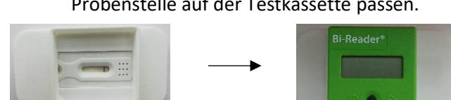
Vergewissern Sie sich, dass das Erkennungsfenster an der Unterseite des Readers frei ist, und setzen Sie den Reader auf den Kassettenhalter. Die abgeschrägte Ecke des Readers muss auf die abgeschrägte Ecke des Halters zeigen.
