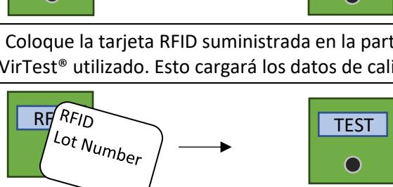
3. Coloque la tarjeta RFID suministrada en la parte superior del lector con la etiqueta correspondiente al lote de Bi-VirTest® utilizado. Esto cargará los datos de calibración pertinentes en el lector.
