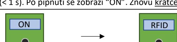
2. Na displeji se objeví nápis „RFID“. Na horní stranu čtečky umístěte dodanou kartu RFID, jejíž označení odpovídá použité šarži Bi-VirTestu. Tím se do čtečky nahrají příslušné kalibrační údaje.
