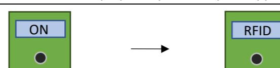
2. "RFID" vises på displayet. Plasser et medfølgende RFID-kort på toppen av leseren. Etikett tilsvarer det brukte partiet av Bi-VirTest. Dette vil laste opp kalibreringsdataene til leseren.
