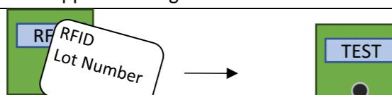
3. Etter pipetonen vises "TEST" i displayet. Trykk på knappen for å vise "RUN". Etter neste pipetonen vises MxA-konsentrasjonen i ng/ml.
